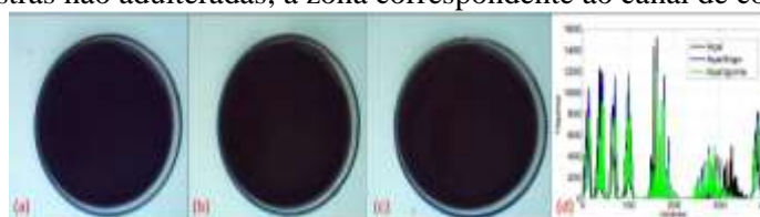
Figura 2: Imagens das amostras de extrato de açaí: (a) não adulterado, (b) adulterado com trigo, (c) adulterado com goma de mandioca e d) histogramas médios para cada classe.
