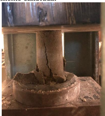
Figura 4 – Corpos de Prova Fibroso no Ensaio de Compressão. (Autora (2019))
