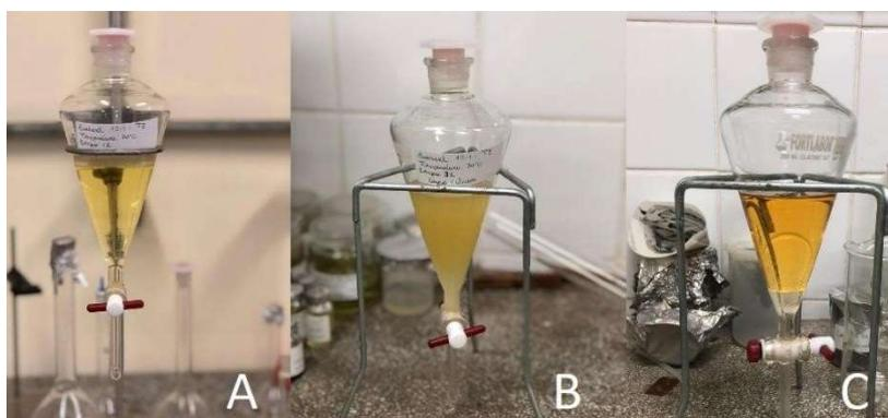
**Figura 3.** Produto decantado da reação de 1, 3 e 5 horas representados por a, b e c respectivamente.
