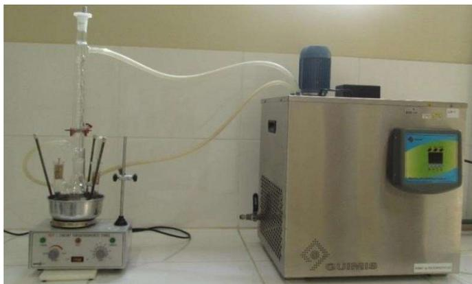
**Figura 2.** Aparato experimental utilizado para reação de transesterificação.
