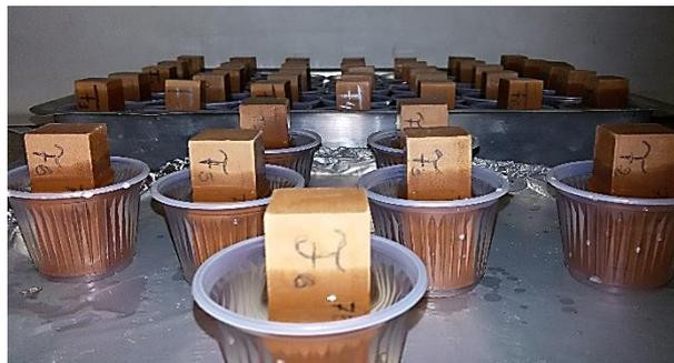
Figura 2: Blocos no ensaio de eflorescência. Fonte: Autor,2019.
