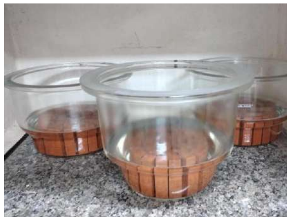
Figura 2: Corpos de prova imersos na solução ácida.
